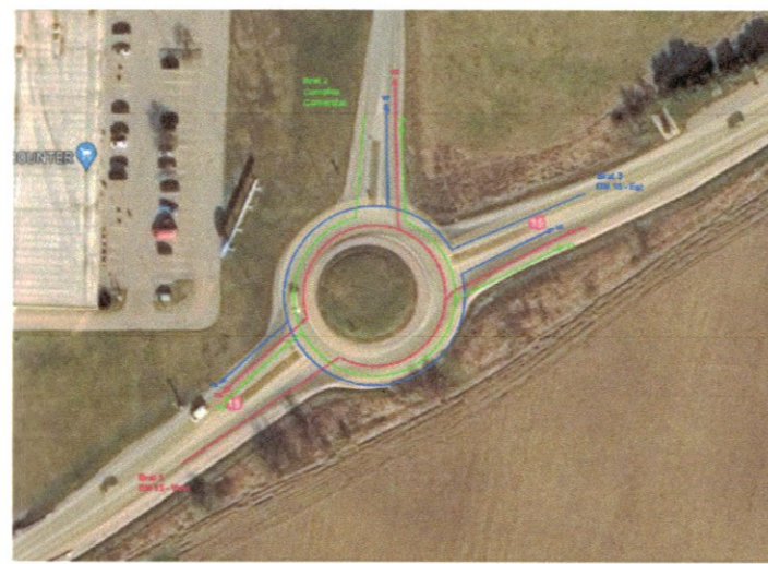
Figura 3-4 Fluxurile de trafic ale intersecției giratorii
